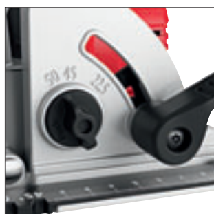
2-krát uchycený výkyvný mechanismus od 0 - 50° Funkce předvoleb pro řezy ve sklonu 22,5° / 45° / 50° pro bezpečné, přesné vedení pily v úkosu. Zabraňuje zaklínění pilového listu do materiálu.
