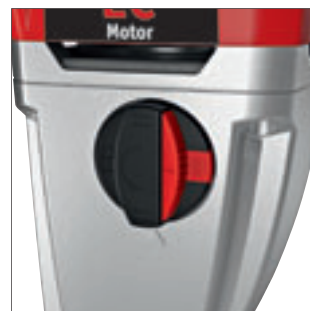
Patentovaná aretace hřídele S ochranou rozběhu pro beznástrojovou výměnu míchací metly. Otočný přepínač pro nastavení optimální rychlosti míchání. Stupeň rychlosti 1: pro vysoce viskózní materiály, stupeň rychlosti 2: pro středně a nízkoviskózní materiály
